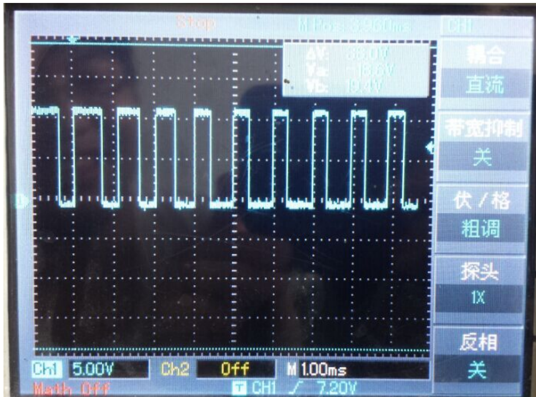
图9 输出 f = 1\text{kHz} 所得方波波形
