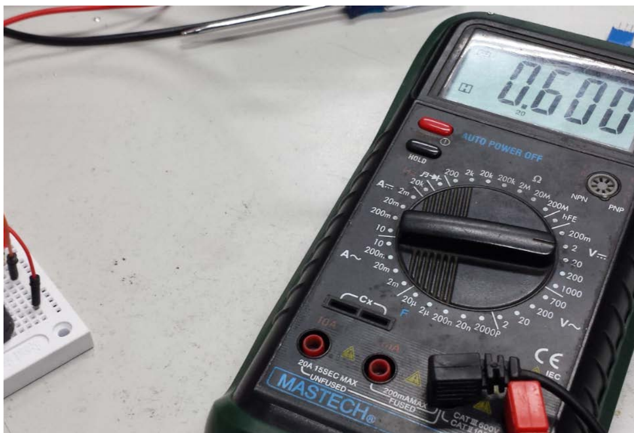
图 37 改进后电路常温下温度传感电路的输出电压测量值
